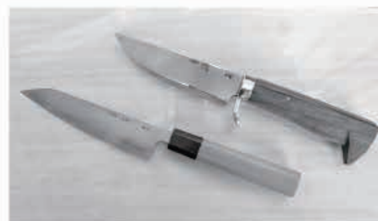
「スタビライズドウッド」の手法により耐久性を高め、錆びにくく、汚れに強い刃物の製品化が進められています。
