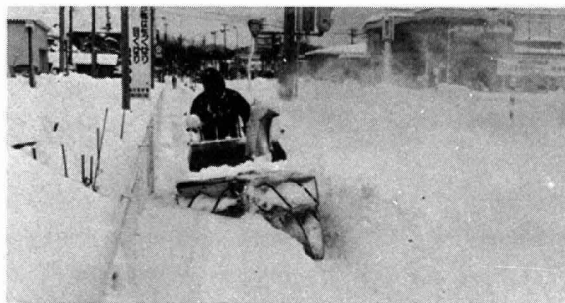
歩道の除雪は小型のロータリー車が活躍
