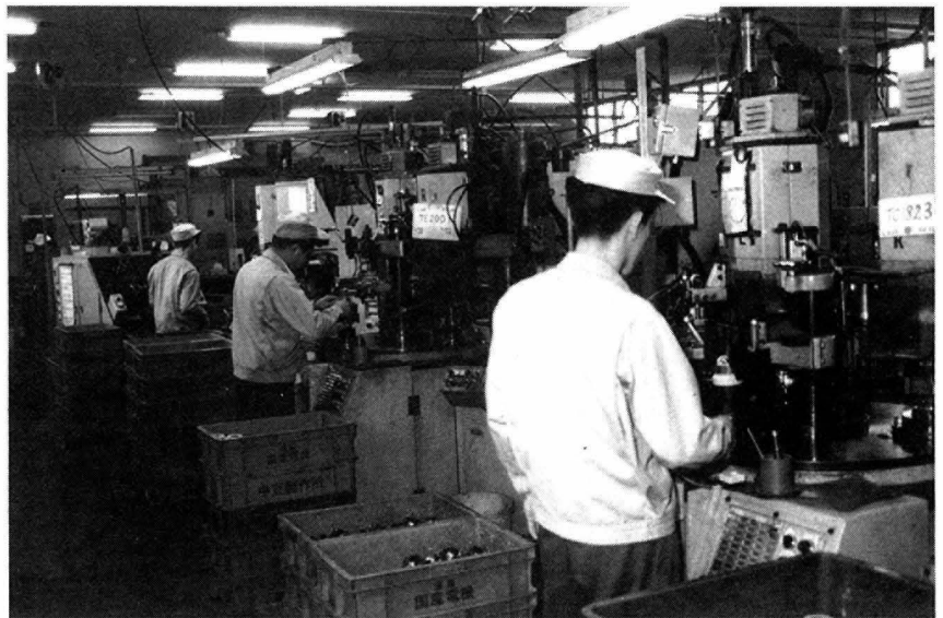
モータコイル自動巻線作業(新工場)
