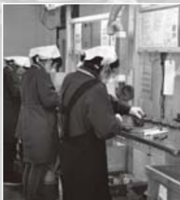
(上)は「高密度巻線機」で銅線を巻く作業。(下)はその後の整備作業。どちらも精密さが要求される。
